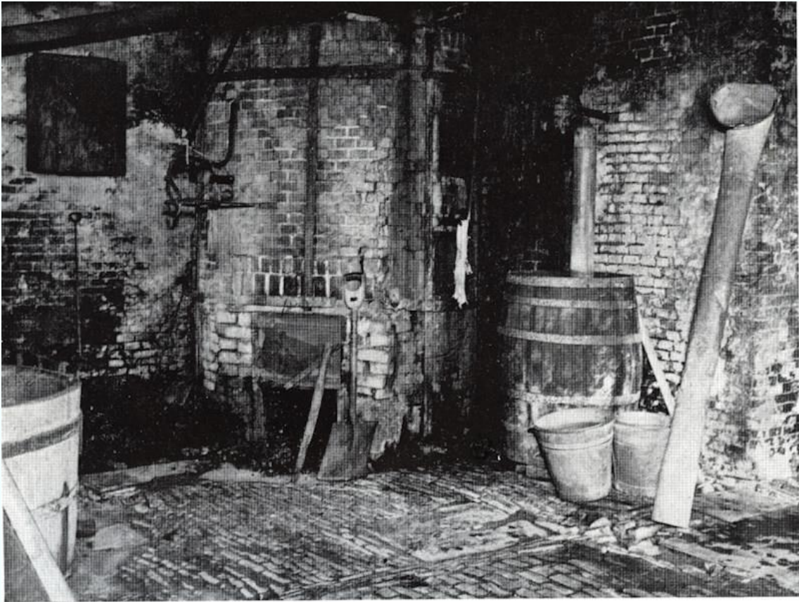
19. De oven met het waterreservoir, de pomp en de goot, die het water naar de kuipen leidt.
